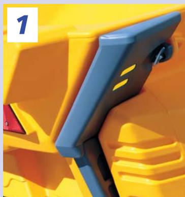
Pour votre sécurité, pensez à porter des gants de protection. Lorsque les déflecteurs sont inactivés (position levée), l'épandeuse est réglée en mode d'épandage par projection.
