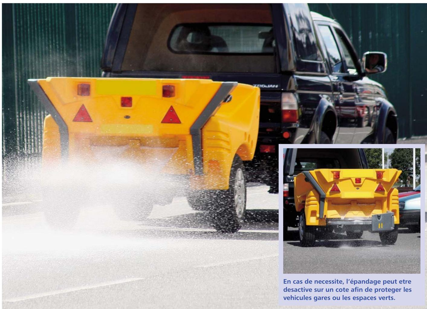
En cas de nécessité, l'épandage peut être désactivé sur un côté afin de protéger les véhicules garés ou les espaces verts.
