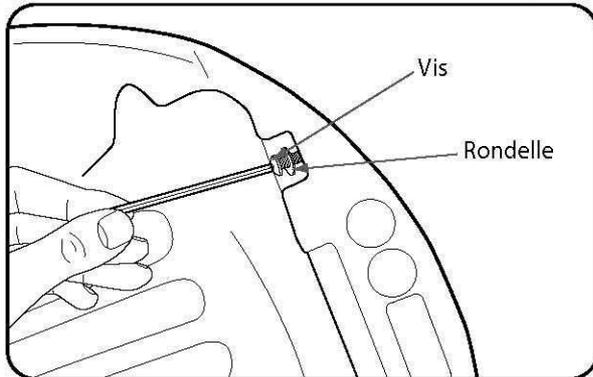
2 Retirez la vis et la rondelle du couvercle (cf. figure ci-dessus) à l'aide d'une clé Allen.
