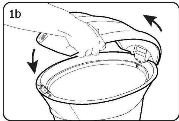
Insérez l'extrémité du couvercle comportant l'axe-pivot dans le support placé au sommet de la poubelle (cf. figure 1a). Faites ensuite pivoter le couvercle vers le bas pour poser l'autre extrémité du couvercle sur le bloc-serrure (cf. figure 1b).
