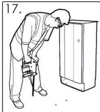
Percez les quatre trous en utilisant une mèche de 16mm pour béton, à une profondeur minimum de 80mm. Enlevez la poussière de béton des trous avec une brosse ou un souffleur.
