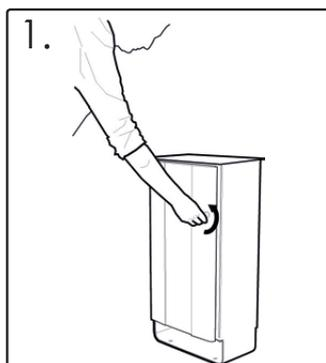
1. Utilisez la clé triangulaire fournie, tournez-la dans le sens inverse des aiguilles d'une montre pour déverrouiller la porte.
