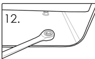
12. À l'aide de la clé de 17mm, positionnez et resserrez les rondelles M10 [ÉLÉMENT 3] et les écrous M10 [ÉLÉMENT 4].
