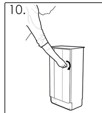
10. Fermez la porte. Tournez la clé triangulaire dans le sens des aiguilles d'une montre pour verrouiller.
