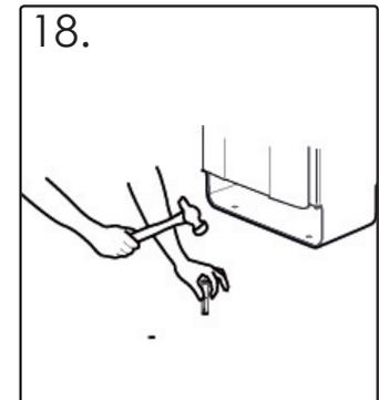
A l'aide d'un marteau, enfoncez délicatement les 4 chevilles d'ancrage au sol (ÉLÉMENT 1) dans les trous.
