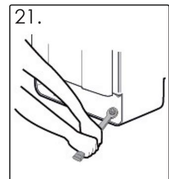
Serrez les vis M10 en utilisant une clé à douille ou une clé de 17 mm (réglage de couple maximum recommandé : 40Nm).
