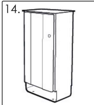
Positionnez la poubelle sur une base de béton ou pavés béton en vous assurant que le trou de fixation est à au moins 110 mm du bord et que le béton est en bon état.
