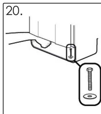
Prenez les vis (ÉLÉMENT 2) et les rondelles (ÉLÉMENT 3) M10 et faites-les passer à travers la base de la poubelle dans les chevilles d'ancrage au sol.
