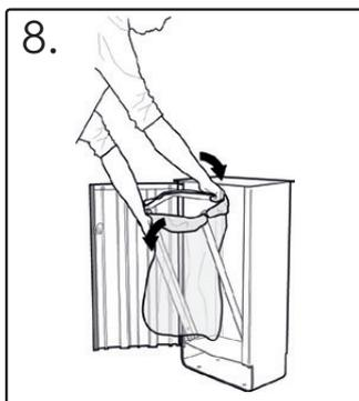
8. Repliez les bords du sac par-dessus sur les bords du système de maintien du sac. Puis rabaissez le support de maintien du sac à l'arrière.
