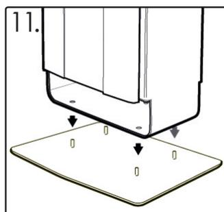
11. Placez la poubelle Electra sur la base autoportante et alignez les trous à la base de la poubelle avec les quatre vis en saillie.
