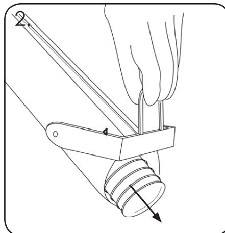
2. En utilisant l'anneau en acier inoxydable, tirez sur le Mécanisme de libération des gobelets pour relâcher les gobelets.
