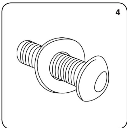
Placez une rondelle sur une vis de 25mm (ÉLÉMENT 2). Depuis l'intérieur de la poubelle, insérer la vis avec la rondelle à travers l'un des 4 trous de fixation à la base du corps de la poubelle.
