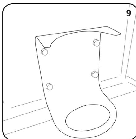
Répétez les étapes 4 à 8 pour les 4 points de fixation afin de fixer définitivement le support du plateau d'égouttement sur le corps de la Nexus 100.
