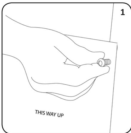
Placez le gabarit papier pour le bas sur le côté droit du corps de la poubelle. Alignez le gabarit avec les trous sur le corps et faites une marque avec un crayon. Utilisez 2 vis M6 x16mm (ÉLÉMENT 1) et 2 boulons (ÉLÉMENT 12) pour fixer de manière temporaire le gabarit à la poubelle.
