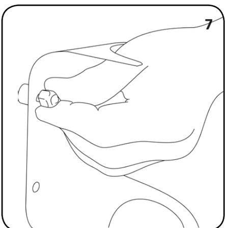
Placez un écrou à tête bombée sur la tige filetée et serrez à la main.
