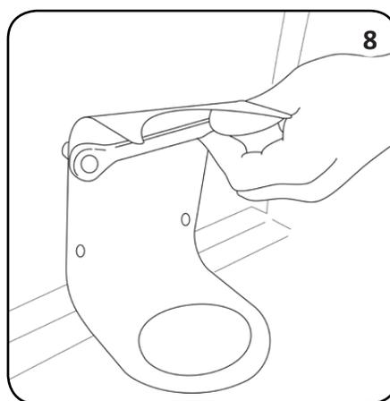
Serrez l'écrou pour sécuriser le support sur le corps de la Nexus 100 avec la clé de 10mm et la clé Allen.
